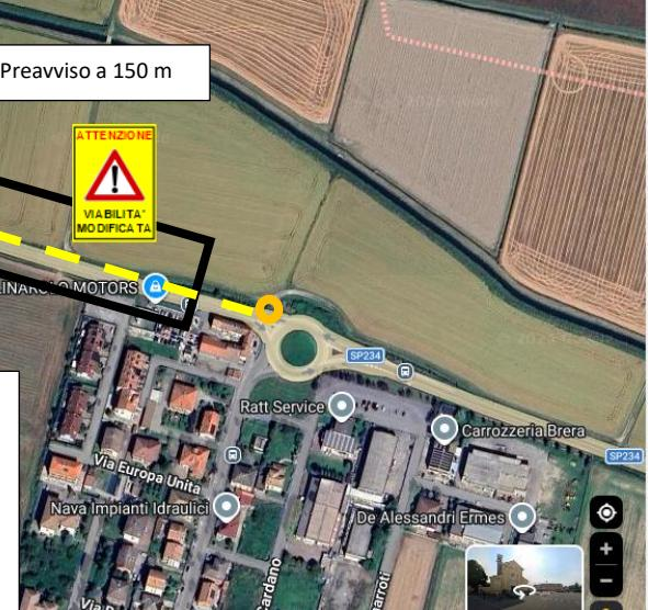
Impianto semaforico con fanali preavvisi 24 H e Impianto sequenziale. (Intervento diviso in tratti di circa 330 m; **ciclo semaforico durata 3 – 3 ½ min**
