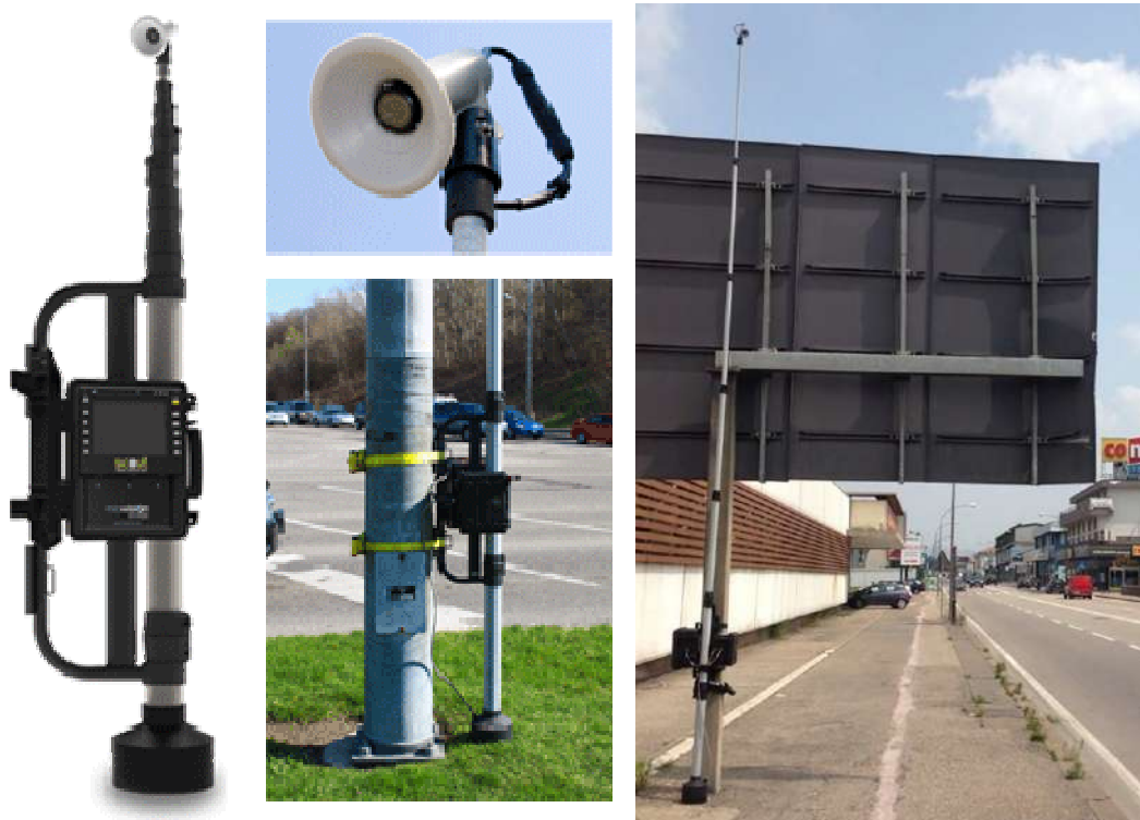
Figura 4 – Strumentazione video con palo telescopico, esempio applicativo
